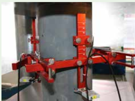
Proefopstelling meting E-modulus.
