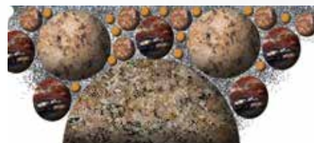
Alle kleine deeltjes (cement, vulstof, fijne delen van toeslagmateriaal en hulpstof) aan de buitenzijde van het beton bepalen de kleur.
