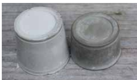
FIGUUR 2: een wcf = 0,6 (links) geeft een lichtere kleur dan een wcf = 0,3 (rechts). Proefstukken zijn gemaakt met 100 gram CEM III/B 42,5 N LH SR en water.
