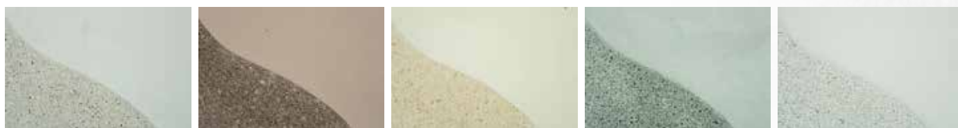
FIGUUR 1: invloed van verschillende toeslagmaterialen op de kleur van beton. Basissamenstelling: wcf = 0,45, wit cement CEM I en kalksteenmeel. Er zijn geen pigmenten toegevoegd.
